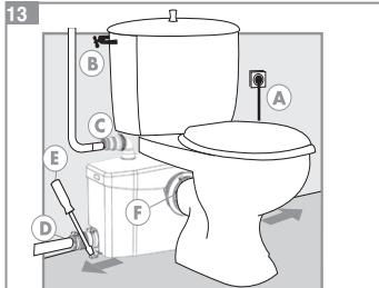
Disegno per lo smontaggio ed il rimontaggio
